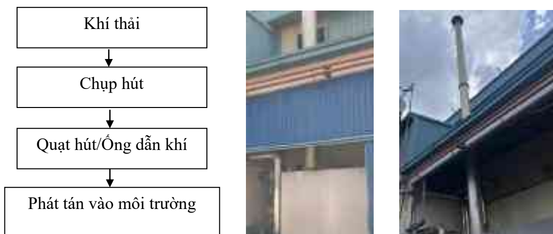
Hình 3. 13. Sơ đồ hút khí tại lò dầu DO
